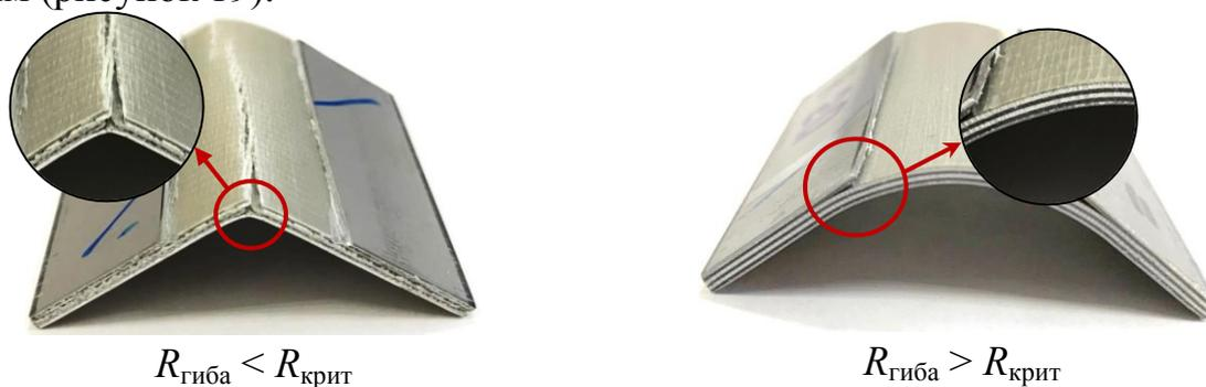
Рисунок 19 – Состояние поверхностей алюмопластика СИАЛ при формообразовании
