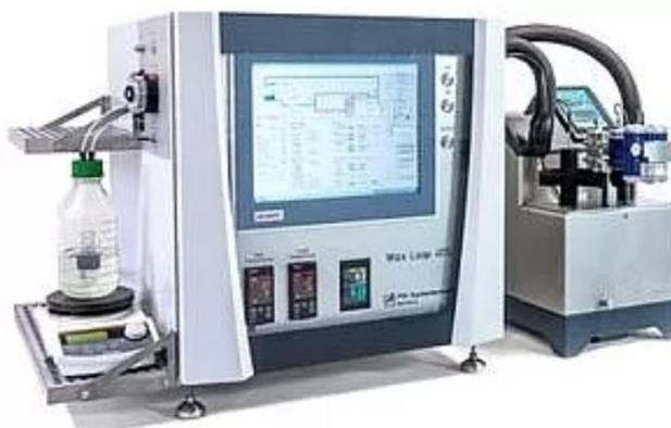
Рисунок 14 - Лабораторный стенд Wax Flow Loop WL [103]
