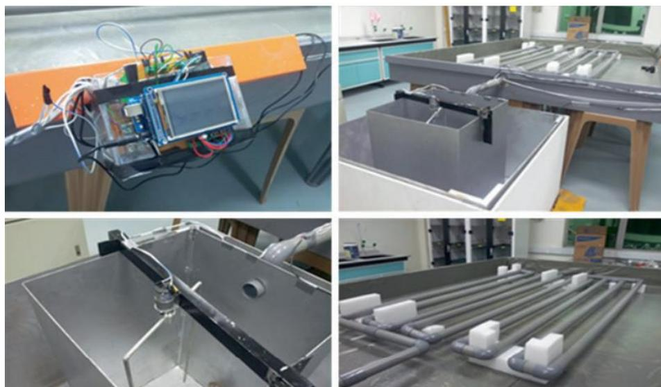
Рисунок 15 - Установка для исследования осаждения парафина [107]
