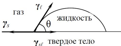
Рисунок 6 - Угол смачивания на поверхности жидкой фазы [95]
