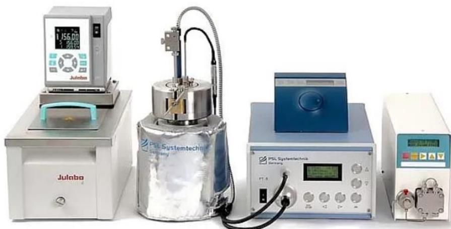
Рисунок 11 - Установка Flocculation Titrimeter System FT5 [103]
