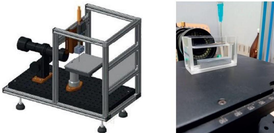
Рисунок 7 – Прибор по определению угла смачивания поверхности жидкой фазой: слева общий вид прибора; справа кювета с прозрачным гексаном в ней, металлическим образцом на дне, иглой шприца сверху
