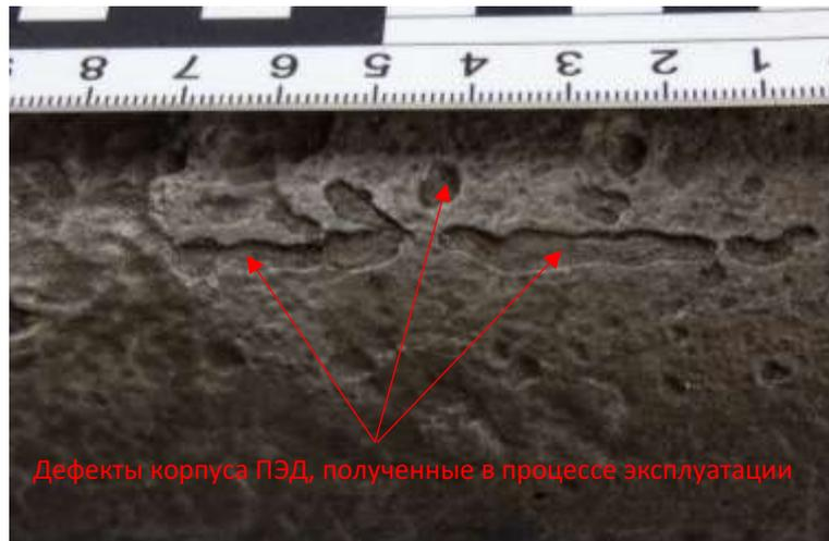
Рисунок 3.20 – Повреждения корпуса ПЭД. Образец №5
