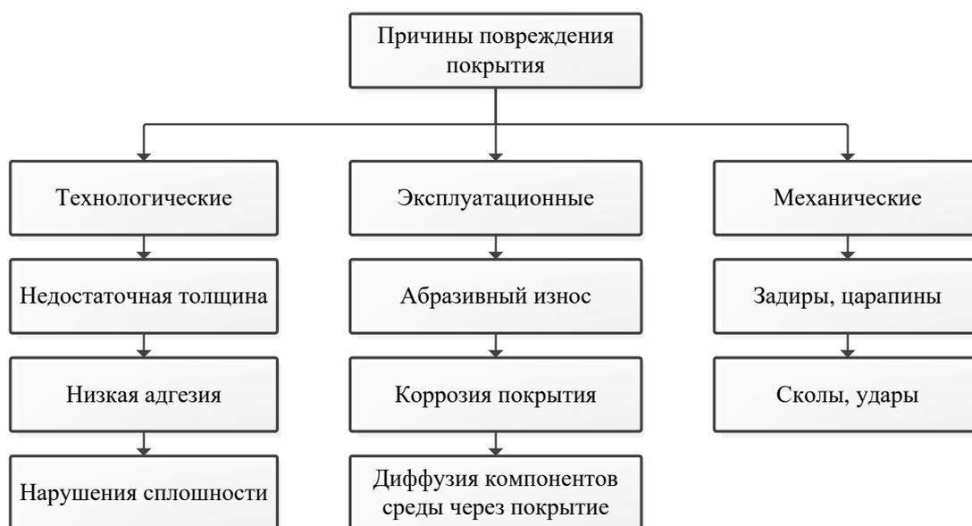
Рисунок 4.1 – Классификация причин разрушения покрытий
