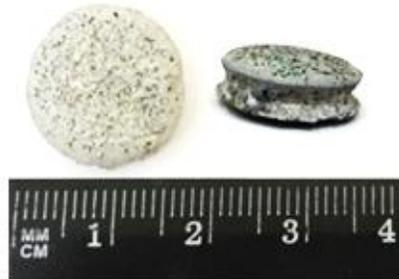
Рисунок 6.7 – Внешний вид образца  $\text{Al}+5\%(\text{AlN}+5\%\text{Na}_3\text{AlF}_6)$ , полученного спеканием в печи СНЗ-8,5.2 с принудительной циркуляцией воздуха при температуре  $\sim 600^\circ\text{C}$  с выдержкой 5 минут
