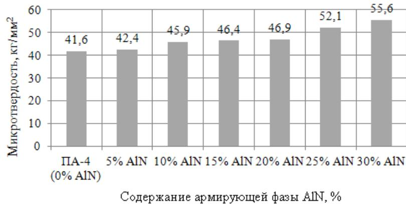
Рисунок 6.6 – Зависимость микротвердости прессованных образцов Al-(AlN+5%Na<sub>3</sub>AlF<sub>6</sub>), приготовленных с добавлением парафина и спрессованных при давлении 300 МПа, от содержания армирующей фазы AlN
