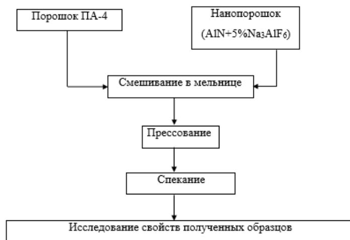
Рисунок 2.3 - Технологическая схема получения АМКМ твердофазным методом
