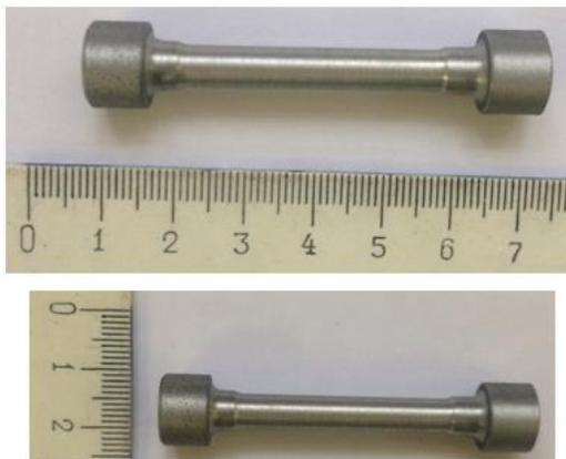
Рисунок 2.7 – Внешний вид образцов для испытаний на растяжение
