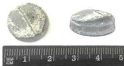
Рисунок 6.9 – Внешний вид образца  $\text{Al}+5\%(\text{AlN}+5\%\text{Na}_3\text{AlF}_6)$ , полученного спеканием в печи GRAFICARBO при температуре  $\sim 600^\circ\text{C}$  с выдержкой в течение 5 минут в защитной среде в виде порошка коллоидного графита
