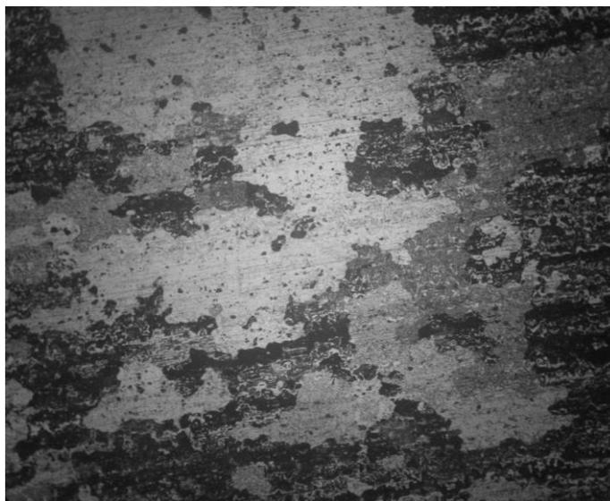
Рисунок 3.1 – Микроструктура листового образца из сплава АМг2 после пластической деформации со степенью обжатия 20% и отжига при температуре 450°С в течение 1 часа, x100 [94]
