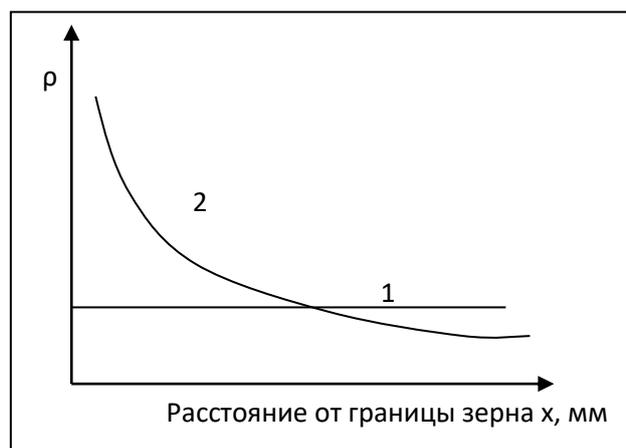
Рисунок 2.13 – Предполагаемая вероятность появления упрочняющих фаз в зерне двухфазного сплава в зависимости от вида обработки: 1 – отожжённое состояние, 2 – закалённое и состаренное состояние [220]
