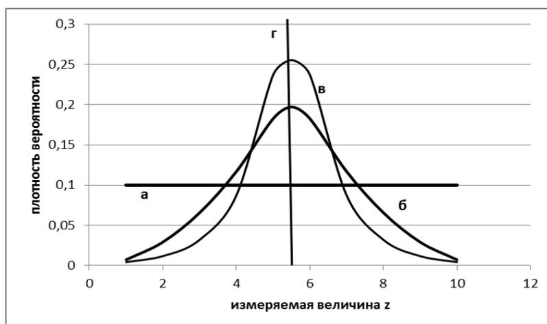
Рисунок 1.2 – Различные виды функций распределения измеряемой величины: а – прямоугольное, б – нормальное с большой дисперсией, в – нормальное с малой дисперсией, г –  $\delta$ -функция (дисперсия отсутствует) [15]
