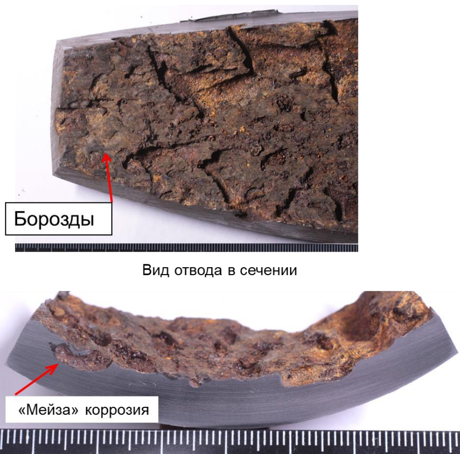
Рис. 1.4 – Вид разрушения отвода из стали 20 в промышленных средах, содержащих \text{CO}_2
