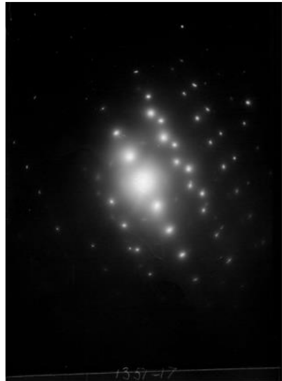
Рис. 5.16 – Микроструктура отводов из стали 05XГБ. Закалка 920 + отп. 600°C (Электронная микроскопия на просвет)
