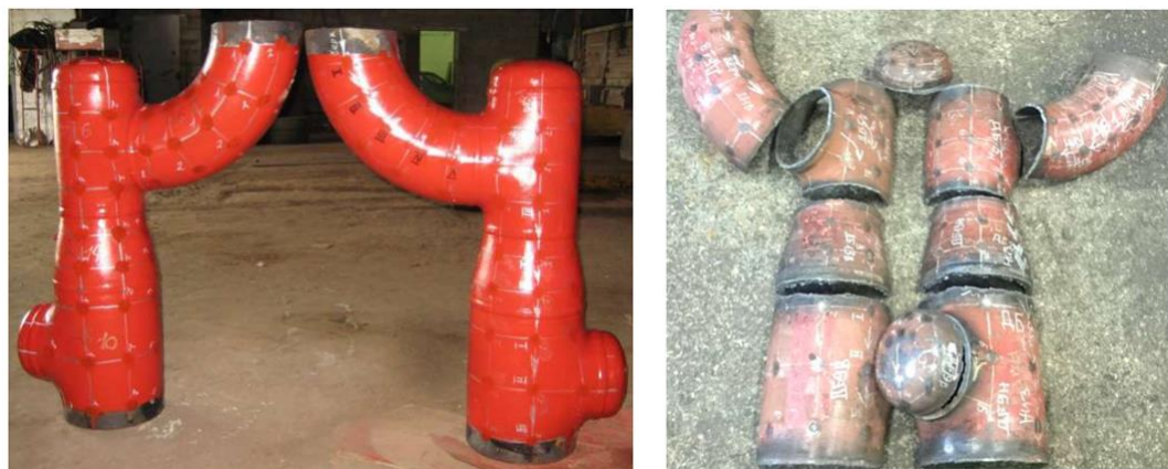
Рис. 2.8 –Трубный узел до и после испытаний
