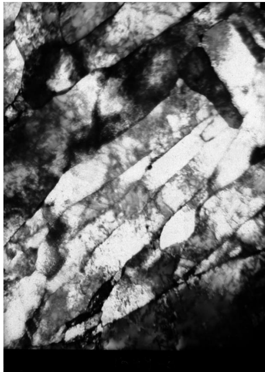
Рис. 5.14 – Микроструктура отводов из стали 05ХГБ. Закалка 920 + отп.400°C (Электронная микроскопия на просвет)
