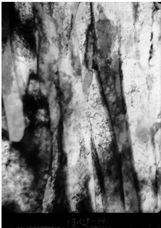
Рис. 5.15 – Микроструктура отводов из стали 05XГБ. Закалка 920 + отп. 500°C.
