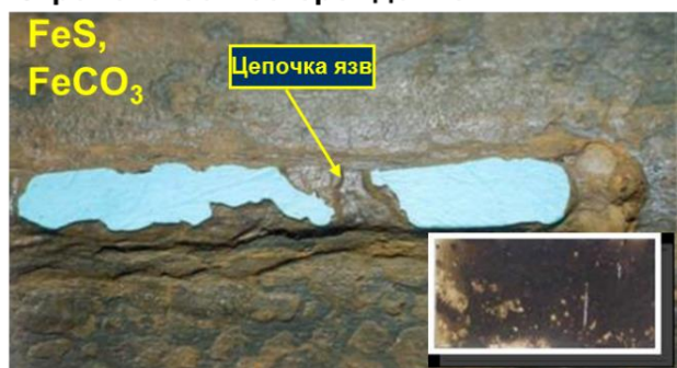
Рис. 1.2 – Виды коррозионных разрушений нефтегазопроводных труб
