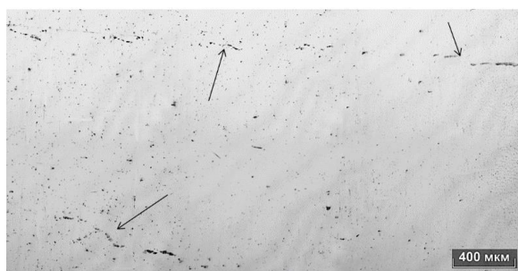
Рисунок 9 - Мелкие поры, выстроившиеся в строчки в материале образца №1, P_{\text{ли}} = 1000 Вт, h = 1,6 мм
