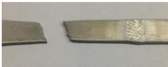
Рисунок 3 – Образец после испытания на растяжение X1,5
