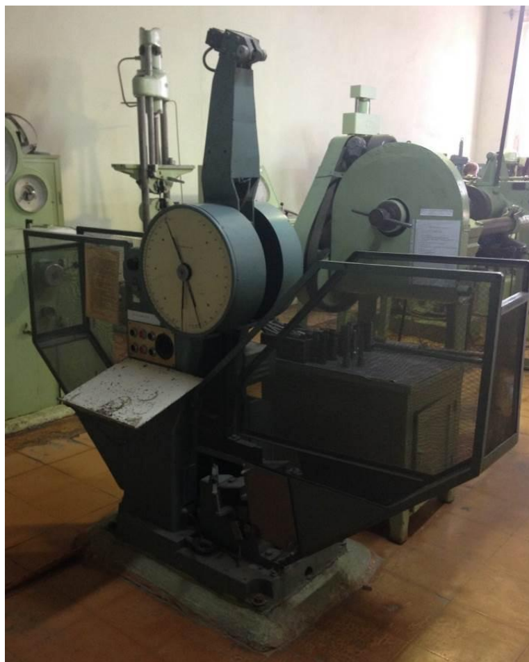
Рисунок 2.8 - Маятниковый копер для испытания на ударный изгиб МК-30
