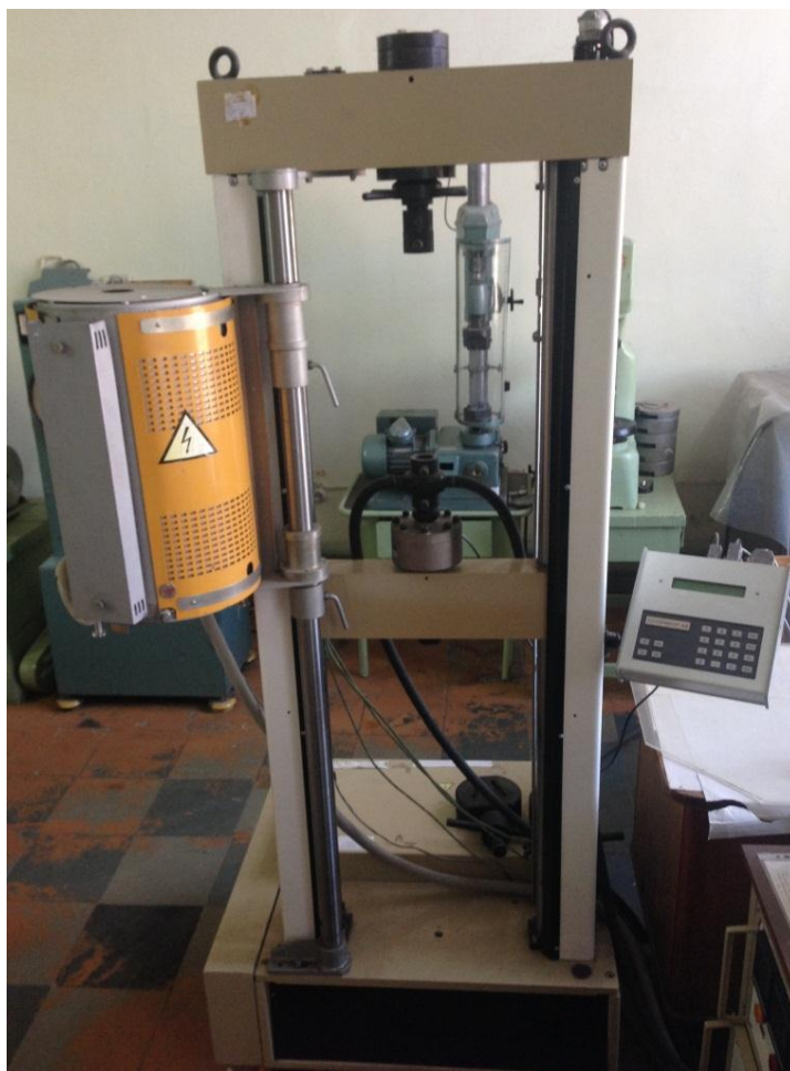
Рисунок 2.6 - Разрывная машина ИР-5047-50
