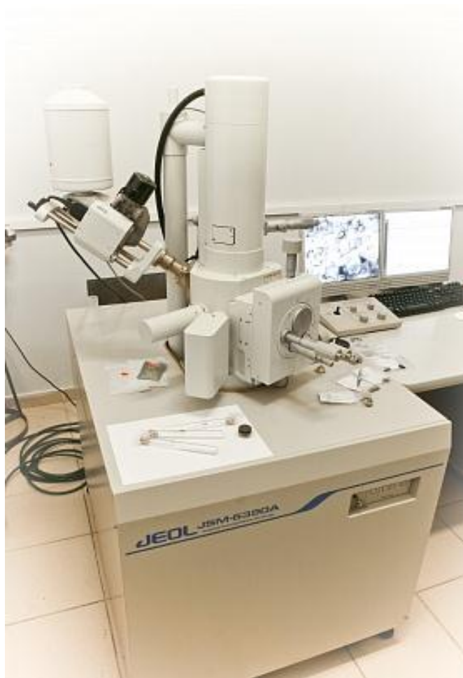
Рисунок 2.2 - Электронный микроскоп JEOL-6390A
