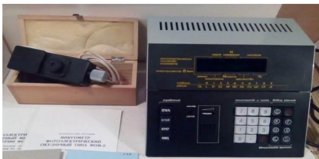
Рисунок 2.5 - Фотоэлектрический окулярный микрометр ФОМ-2-16
