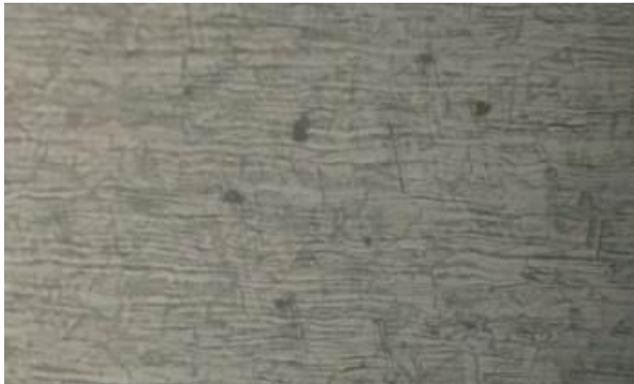
Рисунок 3.17 - Балл зерна сварного шва на натурном узле ( \times 100 )
