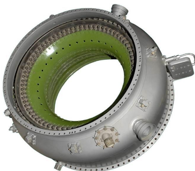
Рисунок 1.4 - Камера сгорания авиационного двигателя НК – 32
