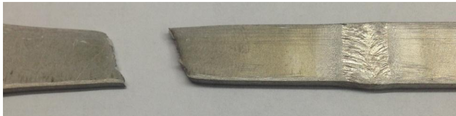
Рисунок 3.24 - Образец после испытания на временное сопротивление X1,5
