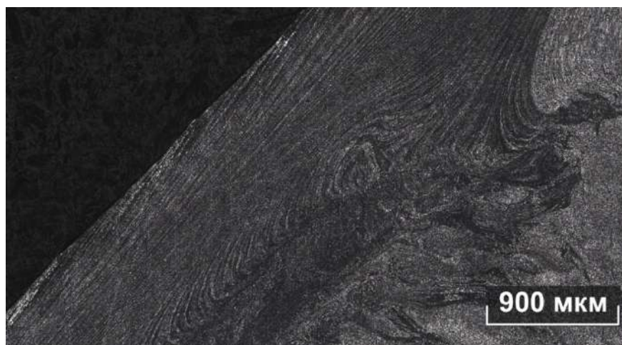
Рисунок 5.13 – Фрагмент подповерхностной зоны на образце, сваренном по режиму 6
