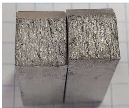
Рисунок 4.17 – Внешний вид излома образца поковки, вырезанного в высотном направлении, испытание при минус 196 °С
