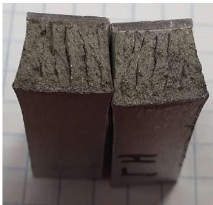
Рисунок 4.16 – Внешний вид излома образца поковки, вырезанного в радиальном направлении, испытание при минус 196 °С
