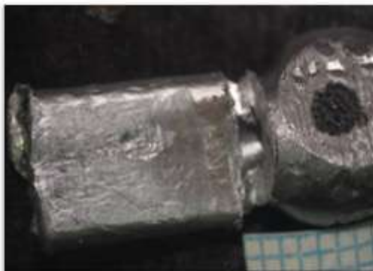
Рисунок 3.12 - Один из сваренных образцов-имитаторов (с удаленной зоной термического влияния) после сплющивания.
