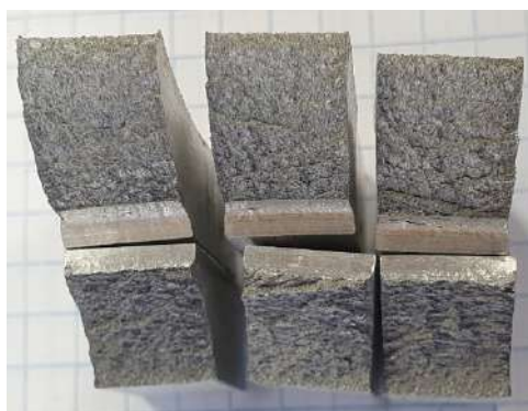
Рисунок 4.15 – Внешний вид излома образцов из поковки, вырезанных в хордовом направлении, испытание при минус 196 °С
