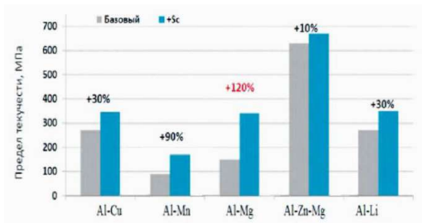
Рисунок 1.6 – Влияние малых добавок Sc на предел текучести алюминиевых сплавов [55]
