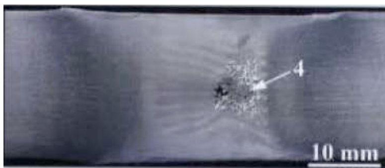
Рисунок 1.11 – Дефект в виде канала, несплошности в области продолжения канала [107]
