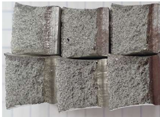
Рисунок 4.13 – Внешний вид излома образцов поковки, вырезанных в хордовом направлении, испытание при плюс 20 °С
