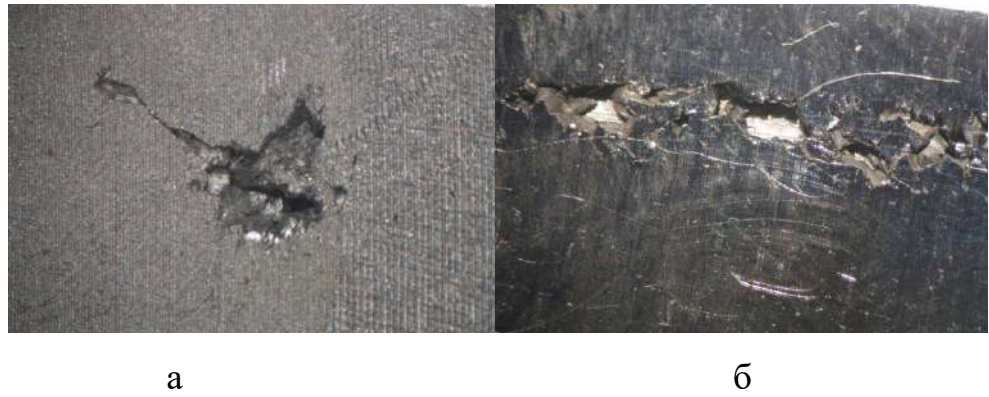
Рисунок 5.5 – Дефект в макроструктуре образца, сваренного по первому режиму: а) поперечное сечение, б) долевое сечение
