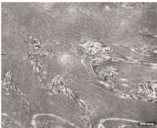
Рисунок 5.3 - Пример неоднородной деформации под мениском в шве
