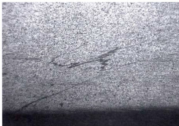
Рисунок 1.13 – Оксидные включения в корневой части соединения сплава 1151Т при односторонней СТП [94]
