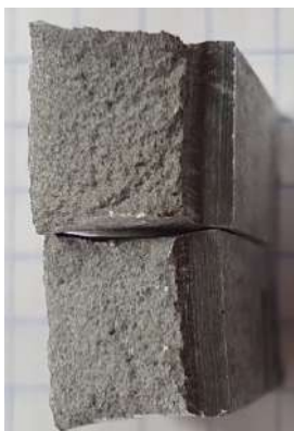
Рисунок 4.14 – Внешний вид излома образца поковки, вырезанного в высотном направлении, испытание при плюс 20 °С
