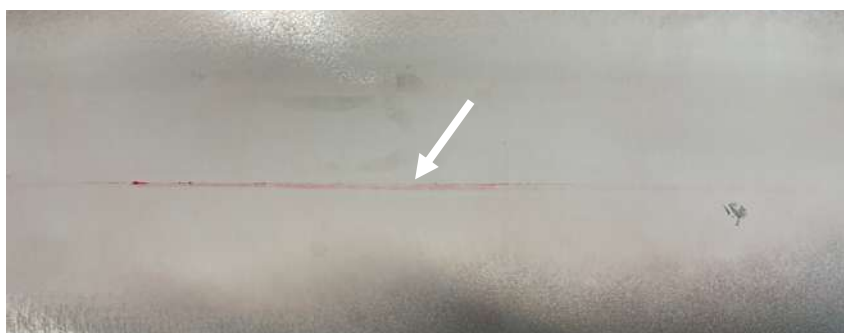
Рисунок 5.40 – Пример внешнего вида недопустимого дефекта в корне шва, выявляемого методом капиллярного контроля
