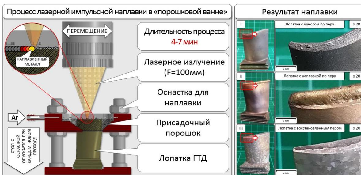
Рисунок 2 – Процесс лазерной импульсной наплавки в «порошковой ванне» с применением универсальной модульной оснастки
