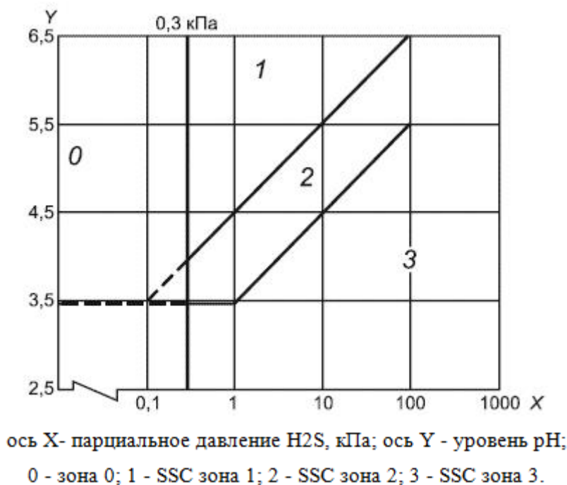
Рисунок 9 - Зоны агрессивности сред в отношении коррозионного растрескивания углеродистых и низколегированных сталей [94]
