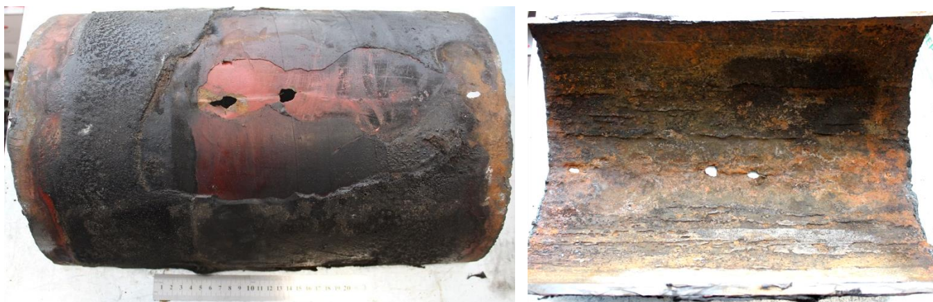
Рисунок 14 - Внешний вид фрагмента трубы из стали марки 13ХФА после эксплуатации
