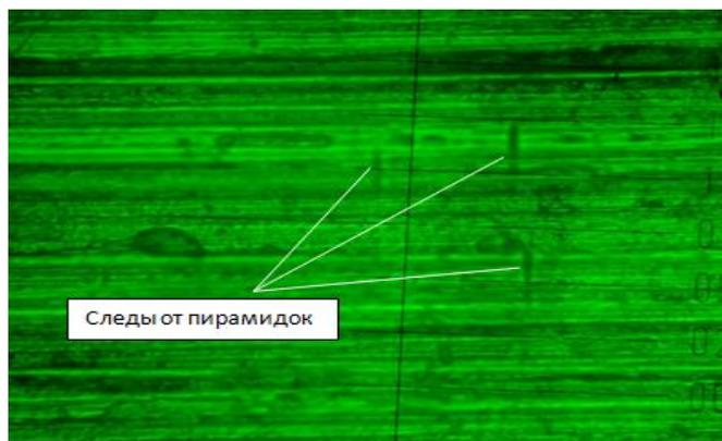
Рис. 5.7. Прерывистый характер отпечатков от пирамидок в неупрочненной зоне образцов типа I
