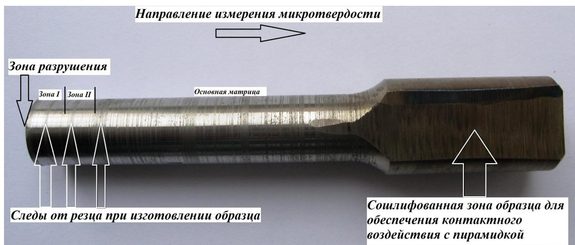
Рис. 5.47. Схема измерения микротвердости
