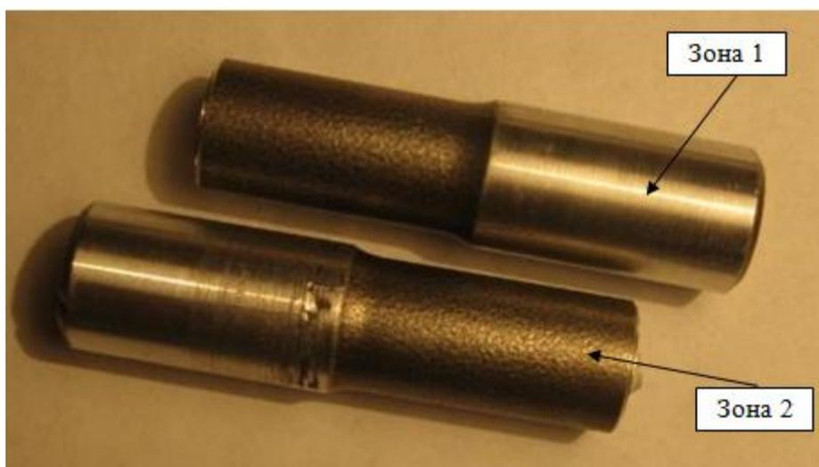
Рис. 5.22. Внешний вид разрушенного образца
