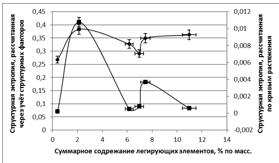
Рисунок 14 – Изменение структурной энтропии листов, рассчитанной по кривым растяжения (■) и с учётом структурных факторов (♦) из исследуемых сплавов в зависимости от суммарного содержания легирующих элементов
