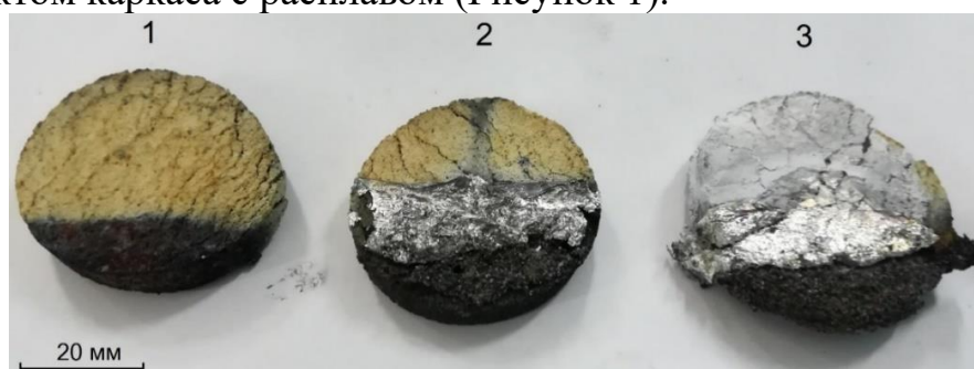
Рисунок 1 – СВС-каркасы TiC (1 – не контактировавший с расплавом Al; 2 – контактировавший, не пропитанный; 3 – контактировавший, пропитанный)
