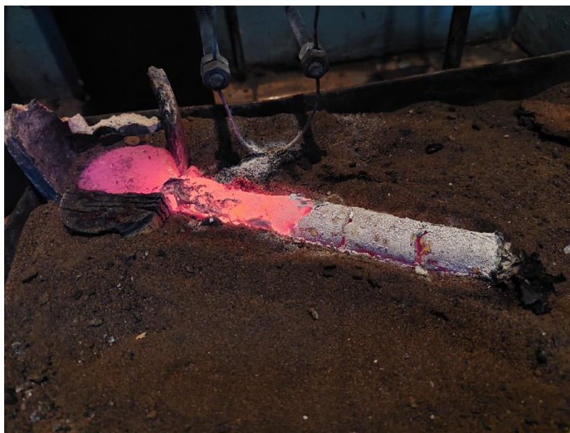
Рисунок 4.52 – Внешний вид остывающего СВС-каркаса после инфильтрации расплавом Cu-10%Si
