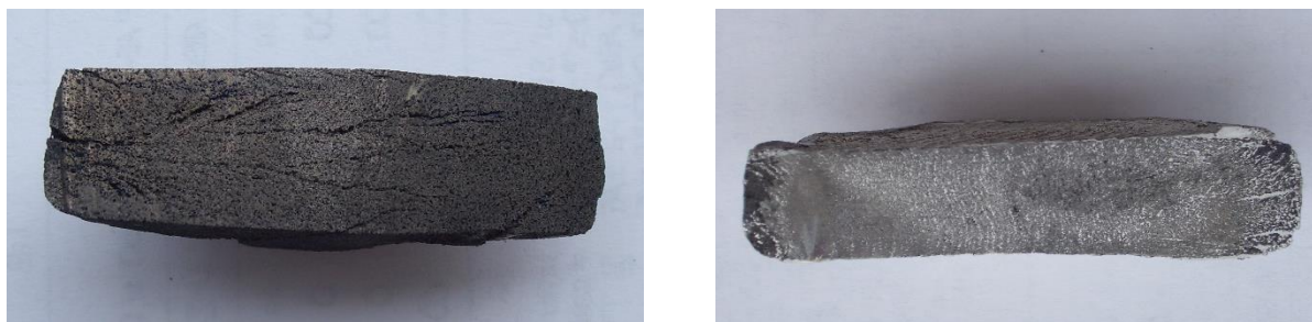
Рисунок 1.2 – Макроструктура каркаса Ti_2AlC (слева) и кермета Ti_2AlC-Al (справа) [95]
