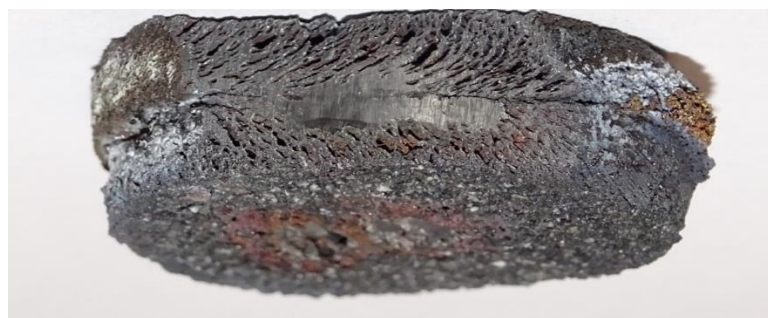
Рисунок 1.4 – Общий вид слоистого образца композита Ti_3SiC_2-Ni , синтезированного из двух шихтовых брикетов по 10 г и брикета никеля 8 г между ними, диаметр 23 мм [98]
