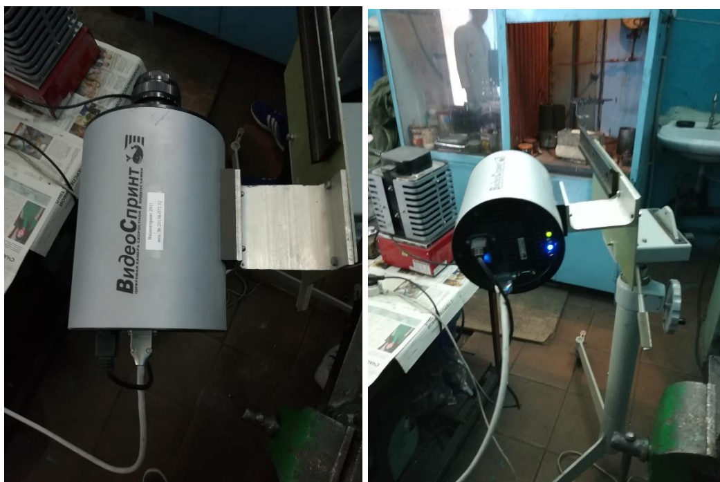
Рисунок 2.10 – Высокоскоростная камера «ВидеоСпринт» (а – вид камеры «сбоку», б – камера, направленная на реактор для проведения эксперимента)
