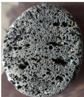
Рисунок 3.8 – СВС каркас Ti_3AlC_2 после механической обработки
