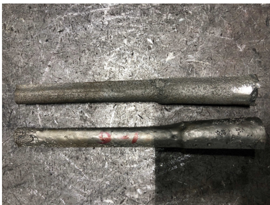
Рисунок 4.7 - Трефовидные заготовки для последующего определения механических свойств
