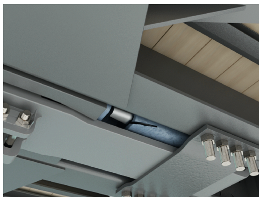
Рисунок 1.3 - Трещина в корпусе эластомерного поглощающего аппарата
