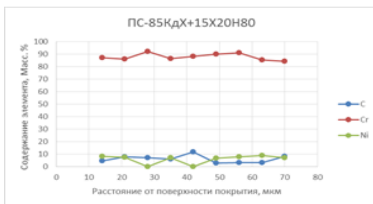
Рисунок 5.7 – Распределение химических элементов по глубине покрытия ПС85К д X+15X20H80
