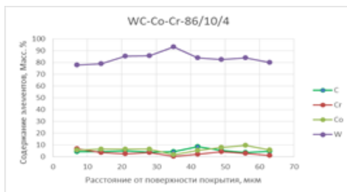
Рисунок 5.10 – Распределение химических элементов по глубине покрытия WC-Co-Cr-86/10/4
