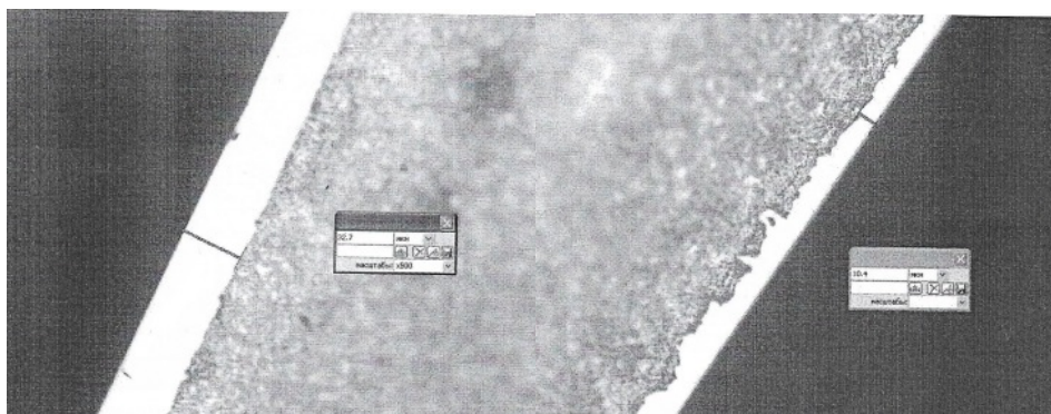
Рисунок 5.2 - Микроструктура хромового покрытия при использовании скорректированного режима обезводороживания
