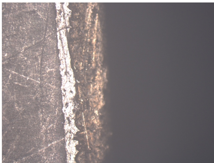
Рисунок 6.1 - Микроструктура покрытия на поверхности сплава BT22
