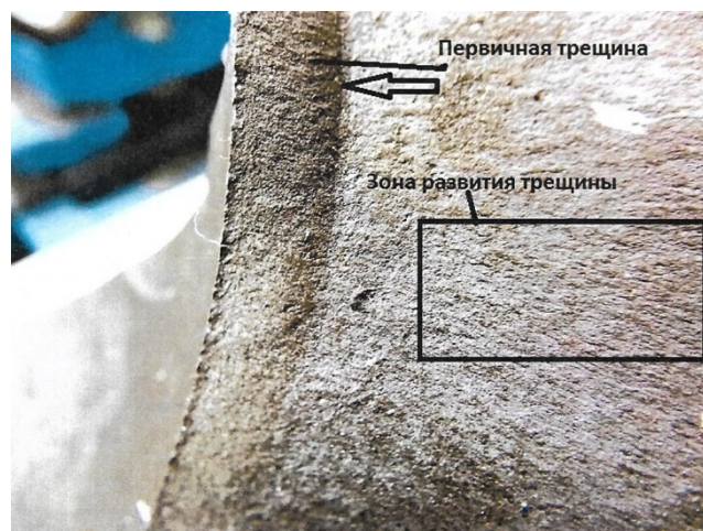
Рисунок 4.2 - Излом корпуса (термическая обработка по режиму №1, табл. 4.4)
