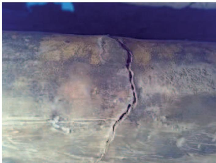
Рисунок 4.7 – Типичные разрушения линейных трубопроводов вследствие распространения трещины: окружная трещина
