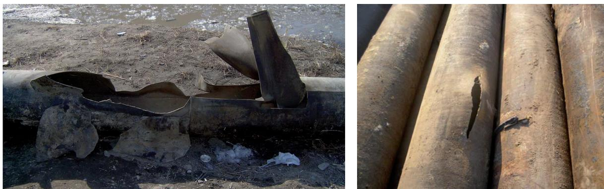
Рисунок 4.6 – Типичные разрушения линейных трубопроводов вследствие распространения трещины
