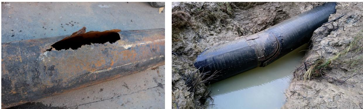
Рисунок 4.5 – Осевая (продольная) и криволинейная трещины в эксплуатационной трубе
