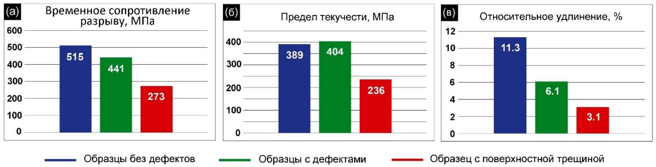
Рисунок 4.30 – Сводные результаты испытаний (а – временное сопротивление разрыву; б – предел текучести; в – относительное удлинение)
